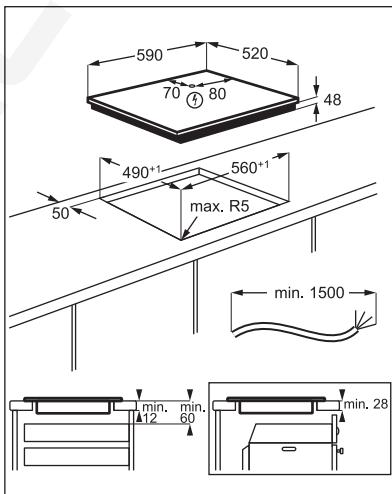
Ha a készüléket egy fiók fölé szereli fel, a főzőlap ventilátora főzés közben felmelegítheti a fiókban elhelyezett és tárolt eszközöket.
